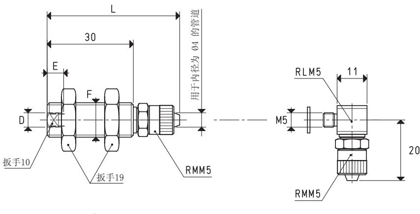
带快插式直接头的吸盘缓冲支杆，可连接塑料管道 Ø 4 X 6
