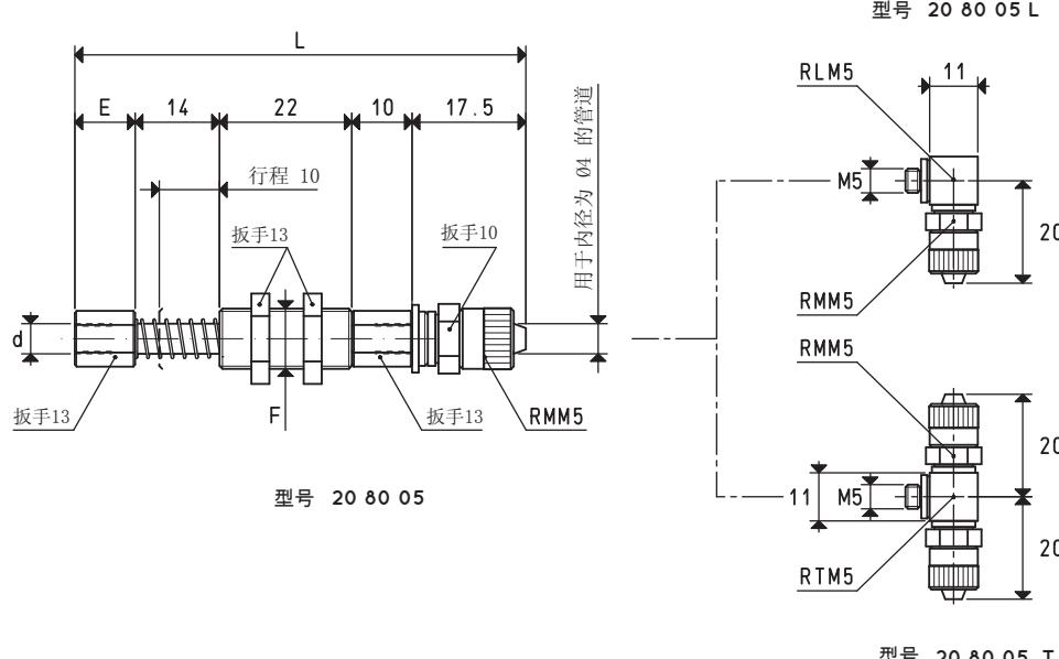
带快插式直接头的吸盘缓冲支杆，可连接塑料管道 Ø 4 X 6
