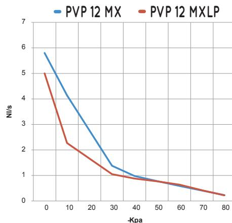
在最佳供气压力下, 不同真空度 (-kPa) 下的疏散时间 (ms/l=s/m<sup>3</sup>)
